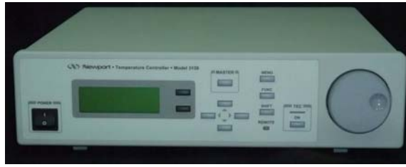
圖 3-4 高功率可調式連續波雷射(Newport, CA, USA)之溫度控制器(temperature controller)
