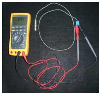
圖 3-6 針型熱電偶與數位式三用電表
