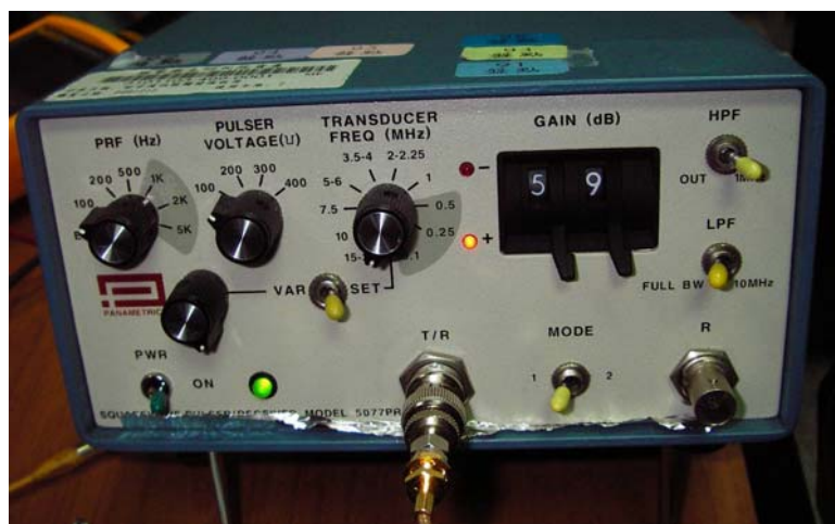
圖 3-8 超音波信號觸發接收器(Model 5077PR，前置放大器 pre-amplifier) (5077PR, Panametrics, Waltham, MA)
