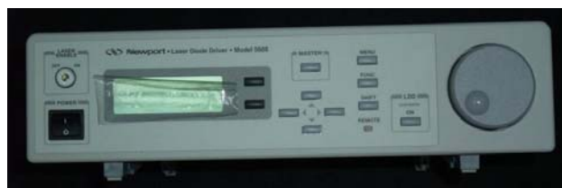
圖 3-3 高功率可調式連續波雷射(Newport, CA, USA)之雷射二極體控制器(Laser diode driver)
