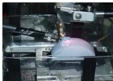
圖4-41 模擬小鼠之瓊脂糖仿體，以PE-50細管插入淺層位置，模擬皮膚腫瘤，並灌注二次去離子水或濃度3nM的金奈米粒子水溶液。上方金黃色物體為光聲超音波
