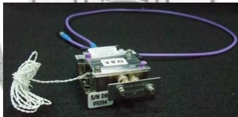
圖 3-2 高功率可調式連續波雷射(808 nm, 最高 10W, Newport, CA, USA)之雷射二極體(laser diode)
