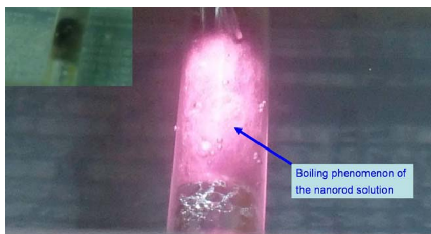
圖4-48 在7.90W的高功率808nm連續波雷射加熱下，金奈米粒子水溶液產生沸騰的現象，雷射關閉後，吸附水溶液的棉花團被燒黑(左上圖)，證明在此情況下，連續波雷射的確將奈米粒子水溶液昇溫至水的沸點以上的溫度，支持利用光聲影像重建的熱影像圖結果。以相同的設施，高功率加熱二次去離子水，或以較低的功率加熱金奈米粒子水溶液，皆未發現沸騰，亦與熱影像圖的結果相符。
