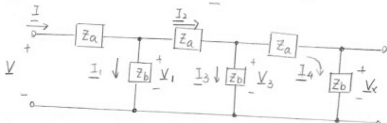
$V_x = R \cdot I = R$ ,  $V_3 = R + jX$ ,  $I_3 = \frac{V_3}{R} = 1 + j\frac{X}{R}$ ,  $I_2 = I_3 + I_4 = 2 + j\frac{X}{R}$
