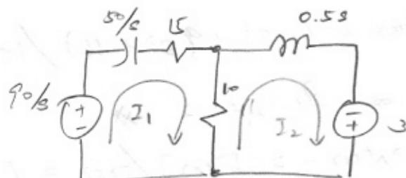
$$\begin{bmatrix} 25 + \frac{50}{s} & -10 \\ -10 & 0.5s + 10 \end{bmatrix} \begin{bmatrix} I_1 \\ I_2 \end{bmatrix} = \begin{bmatrix} 90/s \\ 3 \end{bmatrix}$$
