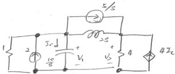
$$\begin{bmatrix} \frac{1}{10} + \frac{s}{10} & \frac{1}{2s} \\ -\frac{1}{2s} & \frac{1}{4} + \frac{1}{2s} \end{bmatrix} \begin{bmatrix} V_1 \\ V_2 \end{bmatrix} = \begin{bmatrix} 0 \\ \frac{5}{s} \end{bmatrix} + \begin{bmatrix} 0 \\ \frac{1}{10} \end{bmatrix}$$
