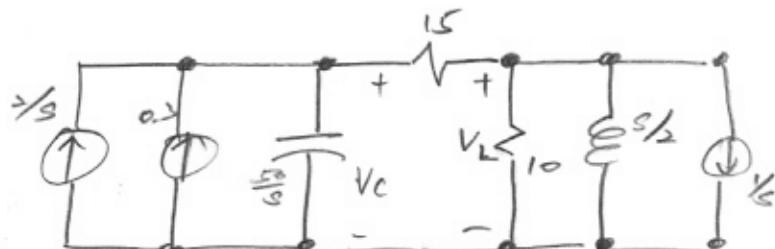
$$\begin{bmatrix} \frac{1}{50} + \frac{1}{15} & -\frac{1}{15} \\ -\frac{1}{15} & \frac{1}{10} + \frac{1}{L} \end{bmatrix} \begin{bmatrix} V_C \\ V_L \end{bmatrix} = \begin{bmatrix} 0.3 + \frac{2}{5} \\ -\frac{1}{5} \end{bmatrix}$$
